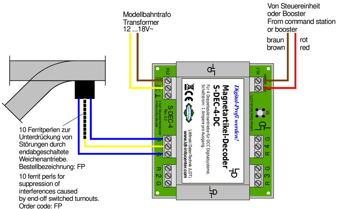
■ Ferritperlen zur Störunterdrückung bei Spulenantrieben (page\_330)
