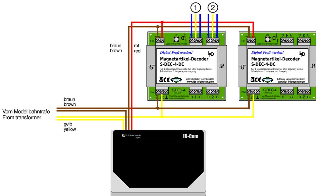
■ Anschluss mehrerer Magnetartikel-Decoder
