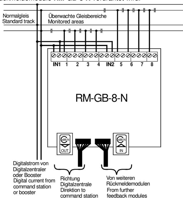
Über die **Eingänge IN1** und **IN2** wird der **RM-GB-8-N** mit **Digitalstrom** versorgt. **IN1** versorgt die **Ausgänge 1 bis 4** und **IN2** die **Ausgänge 5 bis 8**. Die beiden Eingänge **IN1** und **IN2** sind
