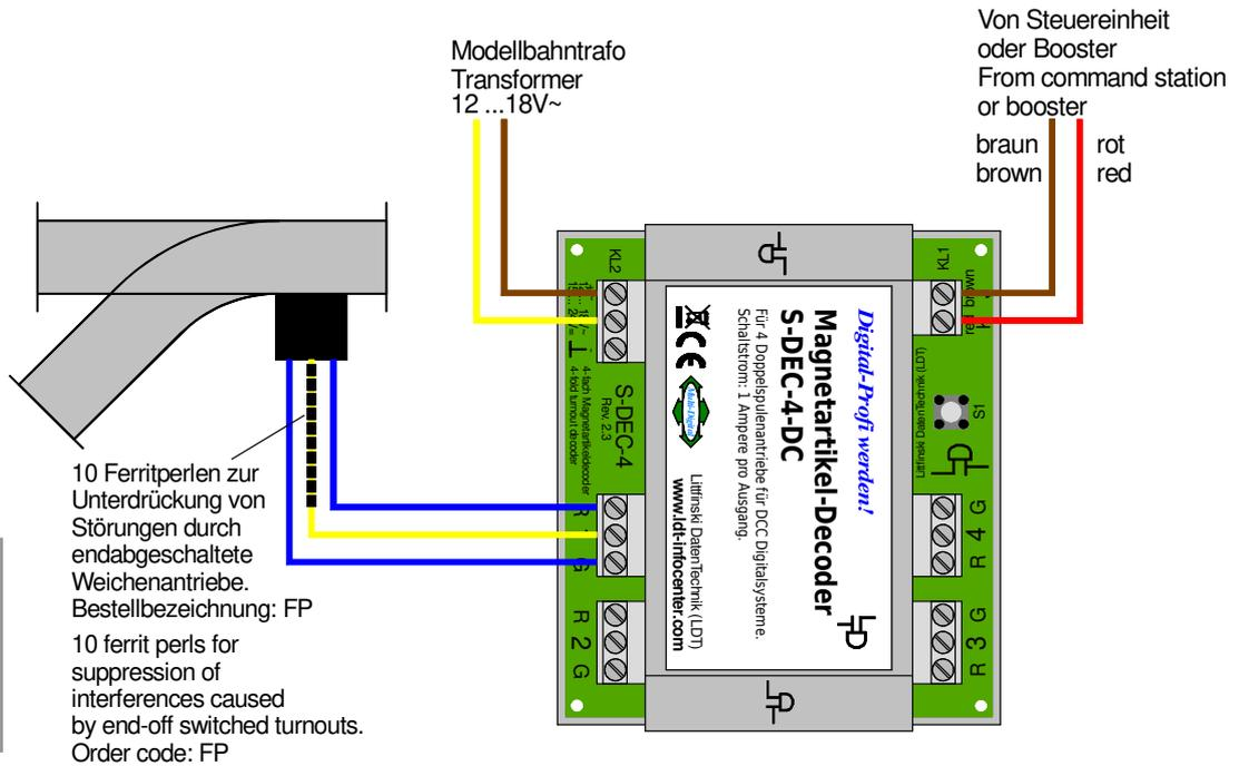
■ Ferritperlen zur Störunterdrückung bei Spulenantrieben (page\_330)
