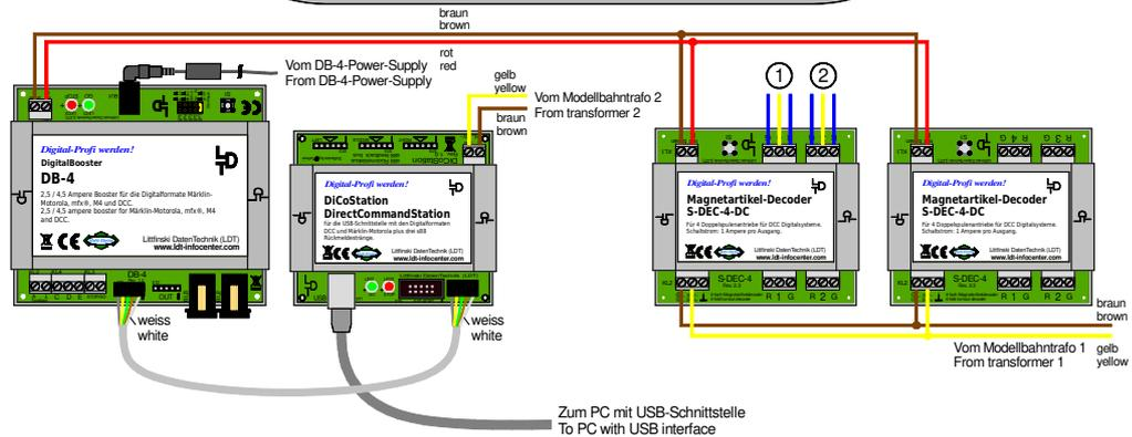
Die Digitalinformation für die Zubehördecoder sollte niemals direkt vom Gleis abgenommen werden. Die mit einem ständigen „Wackelkontakt“ fahrenden Loks können das Digitalsignal so verändern, dass es von den
