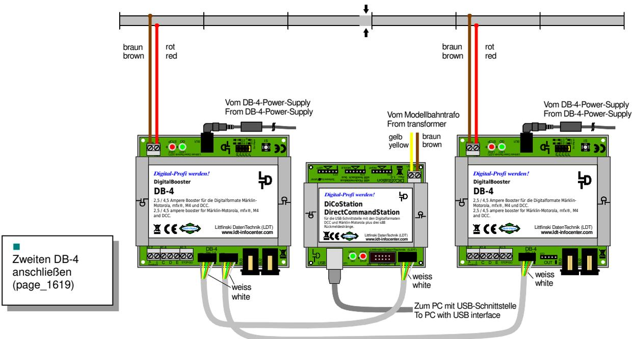
Für die Versorgung des Booster „DB-4“ ist das 120VA Schaltnetzteil „DB-4-PowerSupply“ geeignet. Am „DB-4-PowerSupply“ wird die Versorgungsspannung von 15 bis 24V eingestellt, die der Höhe der Digitalspannung entspricht, die der „DB-4“ ausgibt.
