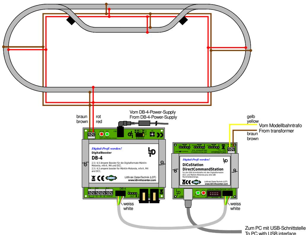
Jede (gesteckte) Gleisverbindung stellt einen elektrischen Widerstand dar, der umso höher ist, je schlechter der Kontakt ist (z.B. durch Korrosion der Steckverbinder). Durch den daraus entstehenden Spannungsfall an den Gleisübergängen mindert sich die Digitalspannung, so dass an „entfernten“ Gleisbereichen möglicherweise nicht mehr die volle
