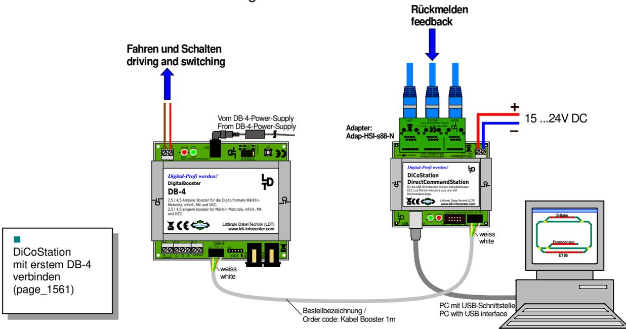
Der zweite DigitalBooster „DB-4“ wird mit dem ersten über ein weiteres Boosterbuskabel „Kabel Booster 1m“ verbunden. Jeder Booster versorgt einen eigenen Gleisbereich. Die Gleisbereiche werden gegeneinander durch Trennstellen elektrisch isoliert.
