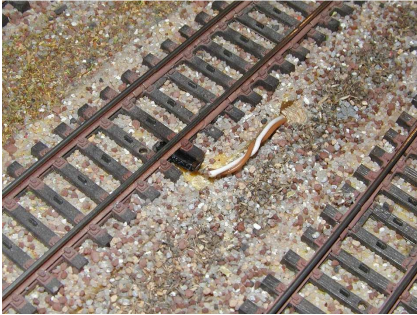
der fertige Rückmelde-Anschluss
