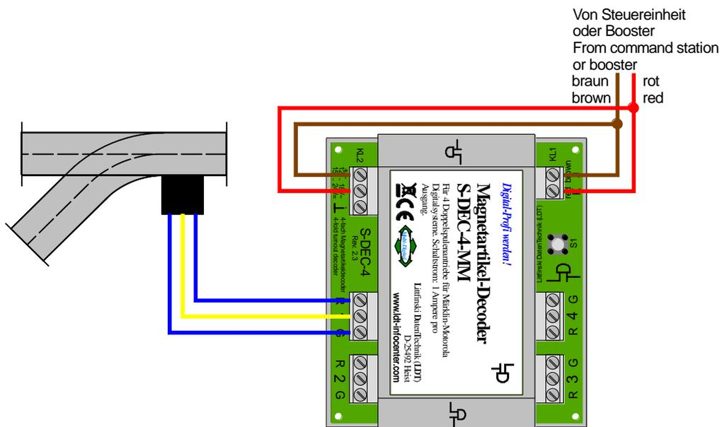
■ Stromversorgung des S-DEC-4-MM über den Digitalstrom (page\_097)
