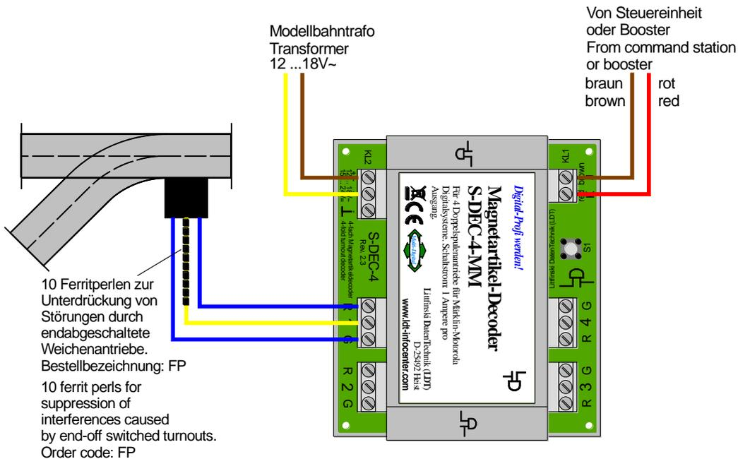
Die Ferritperlen sind als Zubehör unter der Artikelbezeichnung „FP“ bei uns erhältlich. Am Anschluss und an der Bedienung der Weichen sowie an der Programmierung des Decoders ändert sich nichts.
