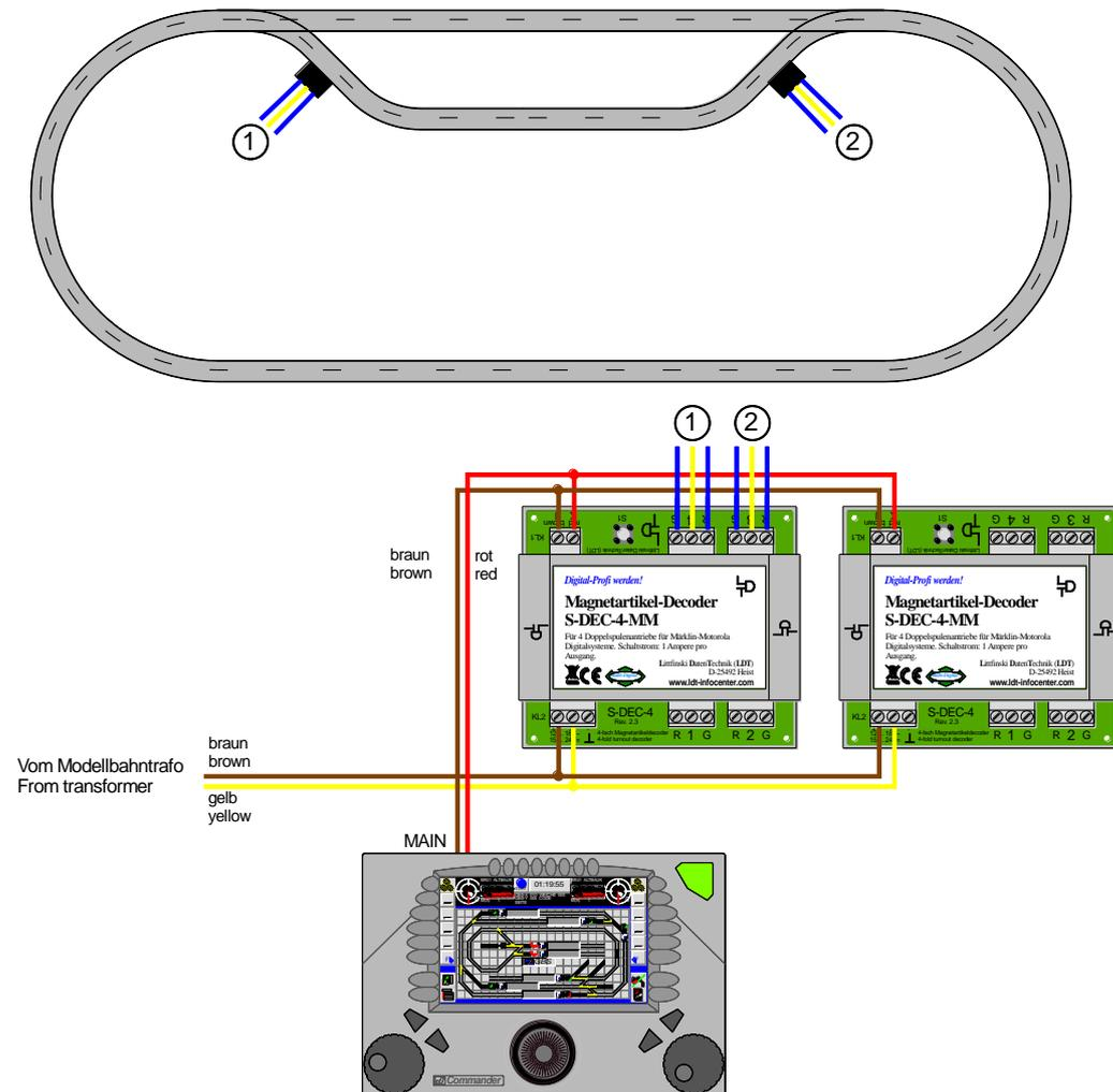
Auch für die Magnetartikel- und Schalt-Decoder empfiehlt sich das Verlegen einer eigenen, zweiten Ringleitung für den Digitalstrom (**rot / braun**) und einer dritten Ringleitung für die Versorgungsspannung (**gelb / braun**).
