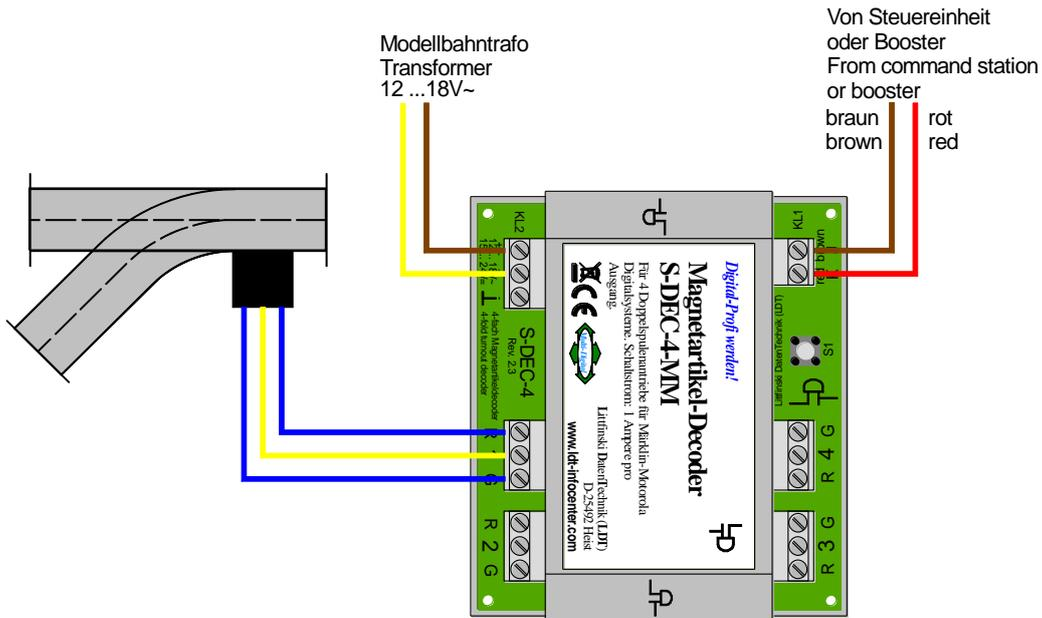
Nicht nur für den Baustein selbst, sondern auch für das Schalten der Spulenantriebe wird eine Versorgungsspannung benötigt (**gelb / braun**). Man kann für den Decoderbaustein von einem Ruhestrom von 0,1 A ausgehen. 1 A ist der maximale Strom, der für jeden der vier Schaltausgänge des Decoders zur Verfügung steht.
