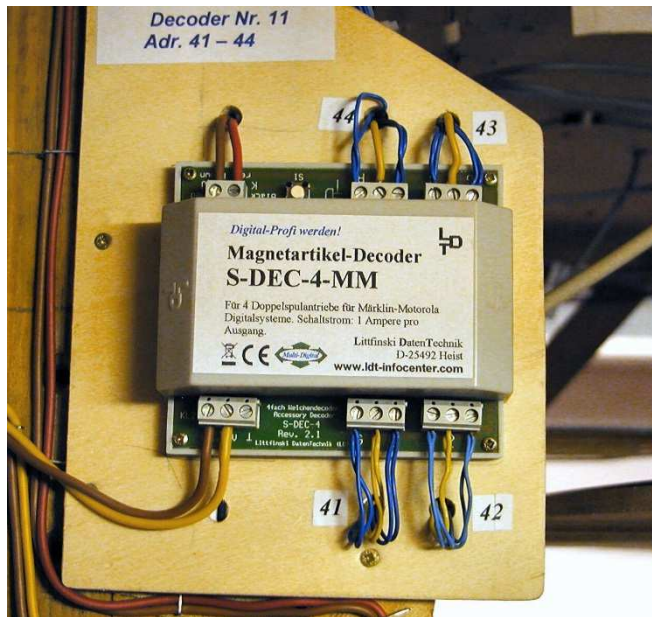
Magnetdecoder auf Sperrholz montiert
