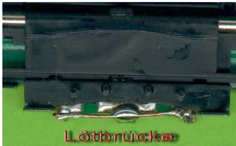
der umgebaut Digitale Weichenantrieb durch eine Lötbrücke
