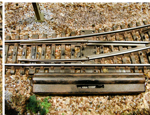
Type 2 met mechanische eindafschakeling
