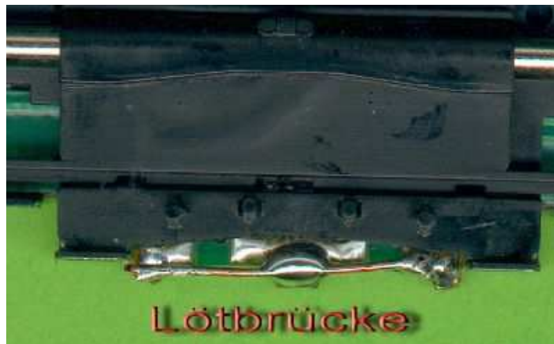
De omgebouwde digitale wisselaandrijving met soldeerbrug
