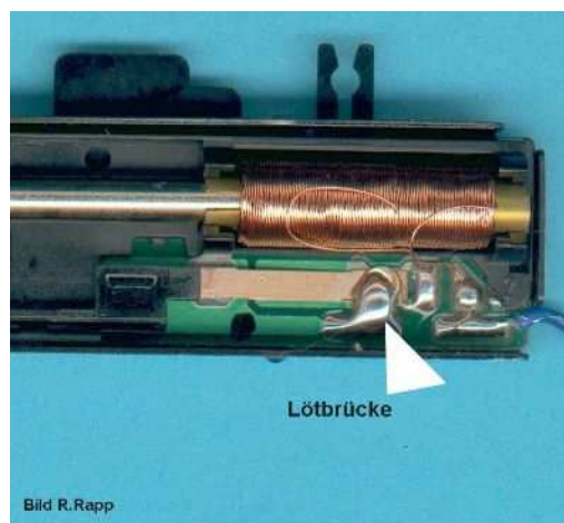
Na ombouw met soldeerbrug
